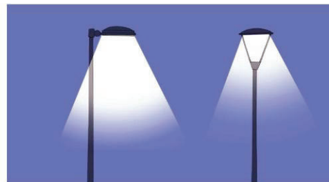
Exemple de mobilier d'éclairage récent. La géométrie du mobilier permet un flux lumineux quasi exclusivement orienté vers le bas et réduisant ainsi substantiellement la pollution lumineuse.
